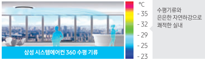
- 기존 4Way 카세트와 360 카세트 자사 비교 테스트 결과 적경 9.3 m 공간에서의 온도 편차가 0.6 °C 이내로 나타남. (14.5 kW 기준)
